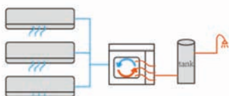
Koeling + SWW (gedeeltelijke warmterecuperatie)
